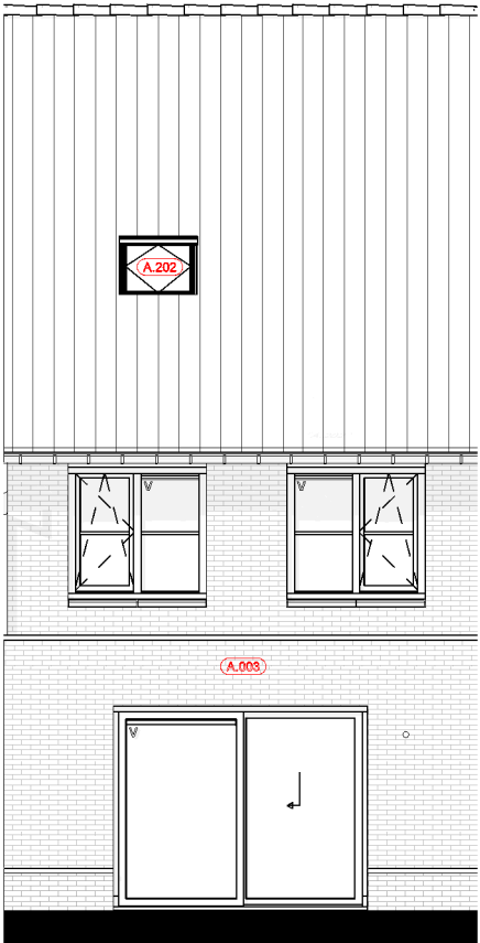
Achtergevel A.003 = Uitbouw achtergevel 2.4m A.202 = Zolderindeling 2; overloop met twee slaapkamers
