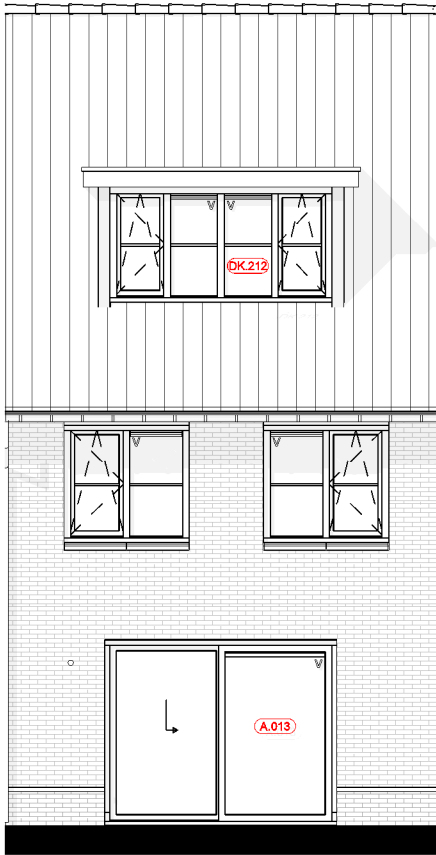
Achtergevel A.013 = Wijzigen schuivend deel schuifpui DK.212 = Dakkapel type 2 (breedte circa 2900mm) achterzijde
