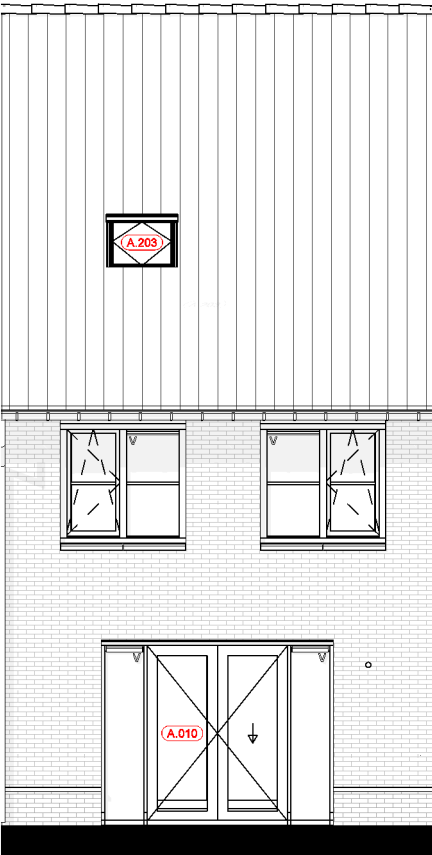
Achtergevel A.010 = Openslaande deur achtergevel met zijlichten A.203 = Zolderindeling 3; ruime overloop met twee slaapkamers
