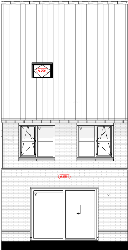
Achtergevel A.001 = Uitbouw achtergevel 1.2m A.201 = Zolderindeling 1; overloop met een slaapkamer
