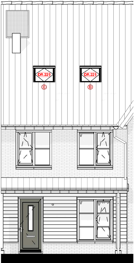
Voorgevel DR.221 = Extra houten tuimeldakraam (ca.980 x 940mm)
