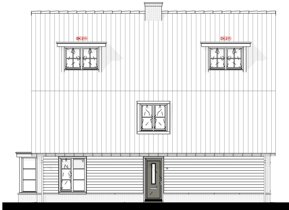
Rechtergevel DK.211 = Dakkapel type 1 (breedte circa 1800mm) achterzijde
