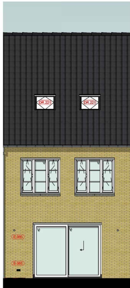
Achtergevel DR.221 = Dakraam ca 940 x980 (A, C) E.063 = Dubbele wcd op achtergevel E.060 = Extra buitenlichtpunt
