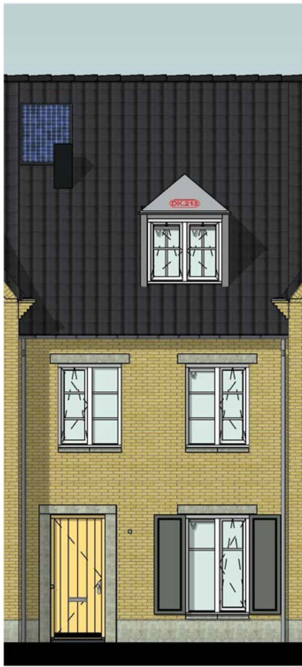
Voorgevel DK.213 = Dakkapel ca.1400mm
