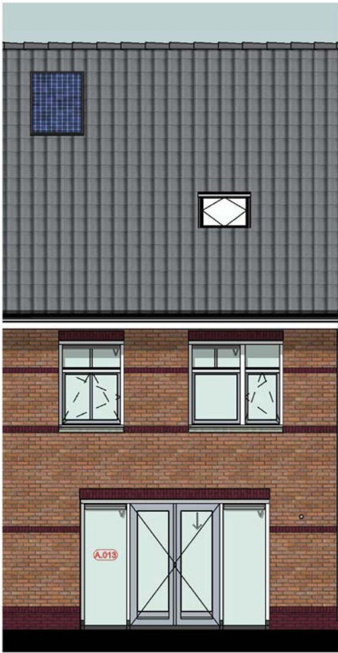
Achtergevel A.013 = Wijzigen loopdeur openslaande deuren DK.211 = Dakkapel type 1 (breedte circa 1,8 m)
