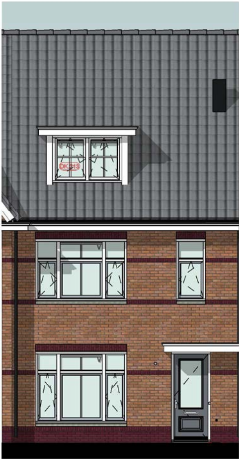
Voorgevel DK.213 = Dakkapel type 3 (breedte circa 1,8 m)
