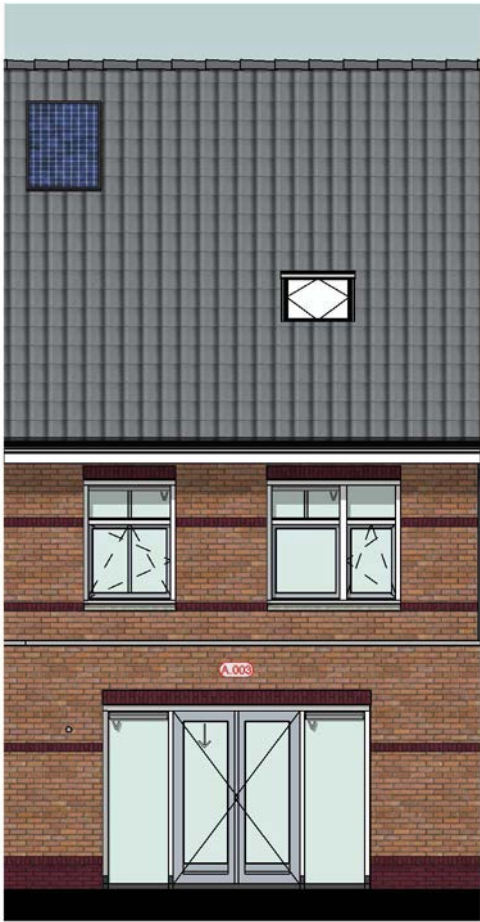
Achtergevel A.003 = Uitbouw achtergevel 2,4m DK.212 = Dakkapel type 2 (breedte circa 2,9 m)
