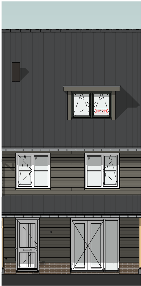
voorgevel DK.211 = Dakkapel ca.1800mm
