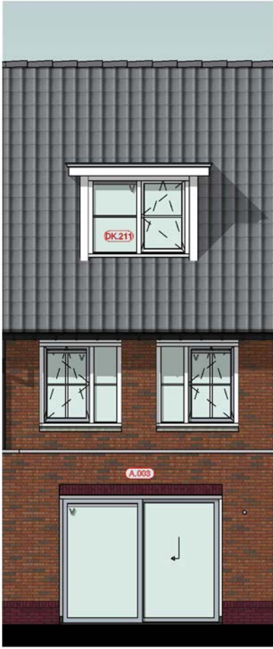
Achtergevel A.003 = Uitbouw achtergevel 2,4m DK.211 = Dakkapel type 1 (breedte circa 1,8 m)
