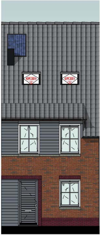
Voorgevel DR.221 = Extra houten tuimeldakraam (circa 980 x 940 mm)
