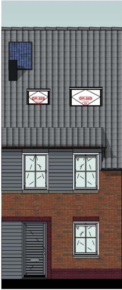
Voorgevel DR.223 = Extra houten tuimeldakraam (circa 1400 x 1140 mm)
