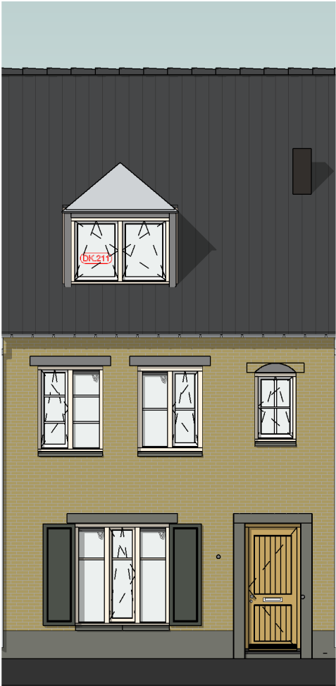
voorgevel DK.211 = Dakkapel ca.1800mm
