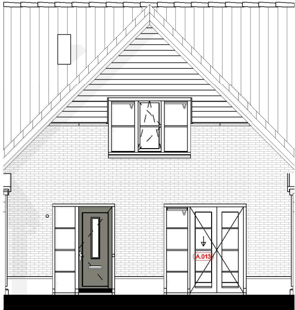
Voorgevel A.013 = Wijzigen loopdeur openslaande deuren
