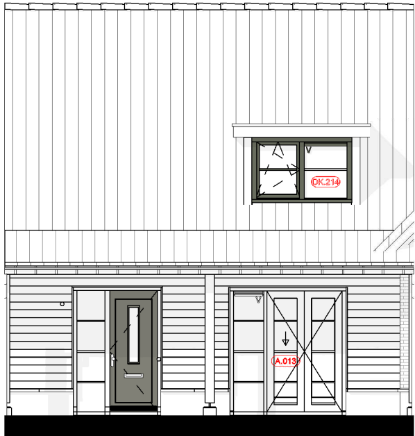
Voorgevel A.013 = Wijzigen loopdeur openslaande deuren DK.214 = Dakkapel type 4 (breedte circa 1800mm) voorzijde
