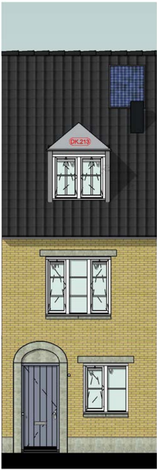
Voorgevel DK.213 = Dakkapel ca.1400mm
