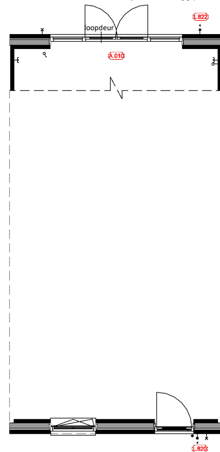
Begane grond A.010 = Openslaande deuren in de achtergevel met zijlichten L.820 = Vorstvrije buitenkraan (gevelplaat) op de voorgevel L.822 = Vorstvrije buitenkraan (gevelplaat) op de achtergevel
