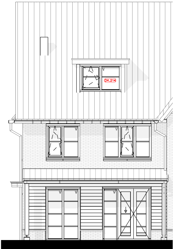
Voorgevel DK.214 = ca.1800 Dakkapel (voorzijde)
