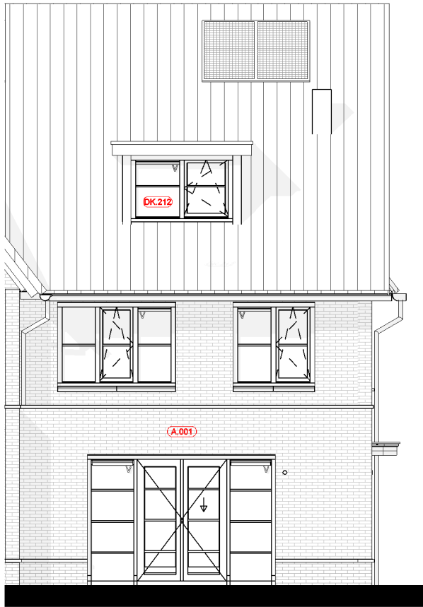
Achtergevel A.001 = Uitbouw achtergevel 1.2m DK.211 = Dakkapel ca.1800mm
