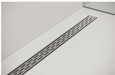
Easy Drain Compact 50 FF RVS douchegoot met slotrooster 70cm | zijuitloop | inbouwdiepte = 83mm | waterslot = 50mm | EDCOMFF700-50 | artikel 2301159
